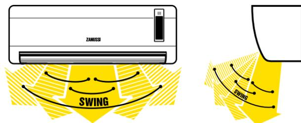
или обогрев комнаты. На эффективность распределения воздуха влияет направление жалюзи, которое задается функцией «Swing»: автоматическое движение воздухораспределительных жалюзи «вверх-вниз». С помощью клавиши можно установить жалюзи в каком-то одном положении, чтобы теплые или холодные потоки воздуха легко и быстро поступали именно туда, где они необходимы.
