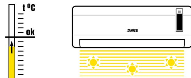
бота этой системы отличается количеством «ступенек» скорости, а, значит, и большей вариативностью. После отключения компрессора внутренний блок еще некоторое время продолжает работать, обеспечивая наиболее равномерное распределение теплого воздуха в обогреваемом помещении.
